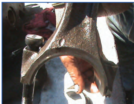
شکل ۱۹۴-۴- جا افتادن قسمت تخت پیچ شاتون در محل آن
