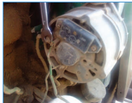
شکل ۳۳-۶ بستن سیم مثبت
