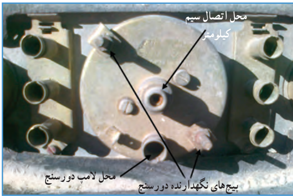
شکل ۸۲-۶- دورسنج از قسمت پشت داشبورد تراکتور U650M
