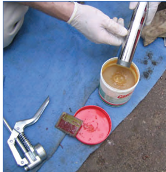
شکل ۴۸-۷- مراحل پر کردن گریس پمپ دستی
