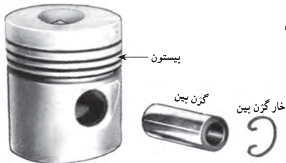
شکل ۳۰-۲- انگشتی و محل نصب آن روی پیستون
