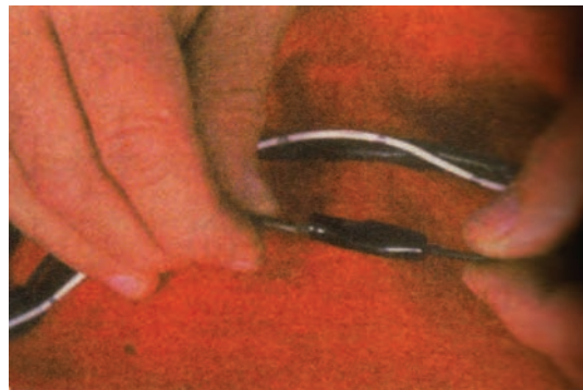
شکل ۶۵-۶- قرار دادن تیوب عایق روی محل اتصال سیم‌ها
