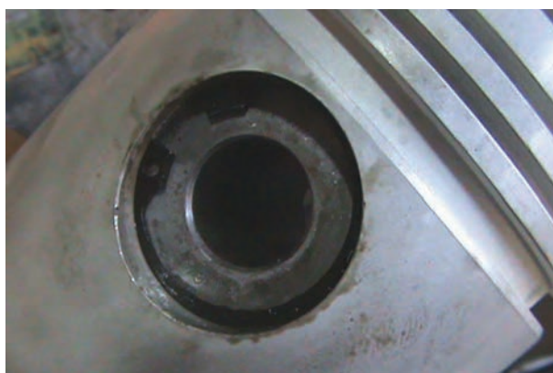
شکل ۱۲۵-۴- جا افتادن خار انگشتی در شیار پیستون
