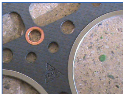
الف) سمت پهن نوار فلزی واشر سرسیلندر
