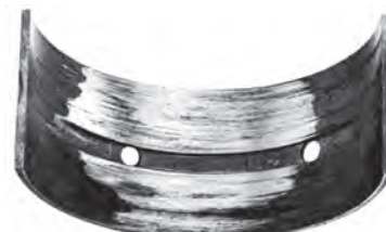
شکل ۱۶۶-۴ سایش یاتاقان به دلیل لقی کم بین میل‌لنگ و یاتاقان
