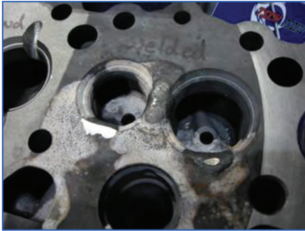
شکل ۲۶-۴- ترمیم ترک سرسیلندر با جوشکاری
