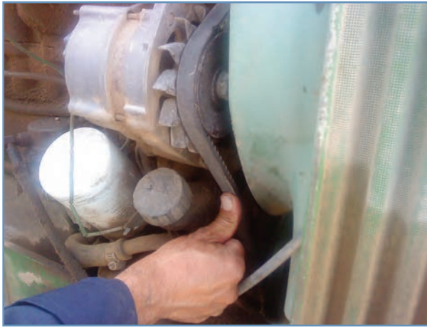
شکل ۲۸-۳- اندازه‌گیری کشش تسمه با فشار انگشت
