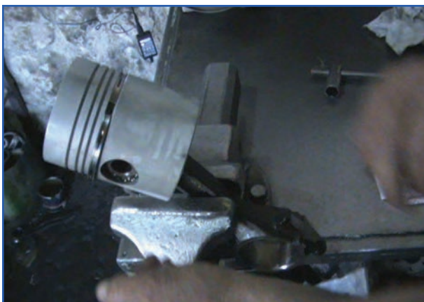
شکل ۱۳۷-۴- طرز بستن شاتون و پیستون به گیره
