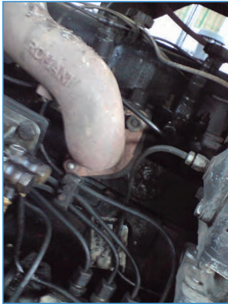
شکل ۳۱-۵- محل اتصال مانیفلد به سرسیلندر تراکتور U650
