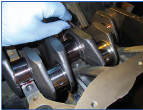
شکل ۱۸۳-۴- خارج کردن بغل یاتاقانی
