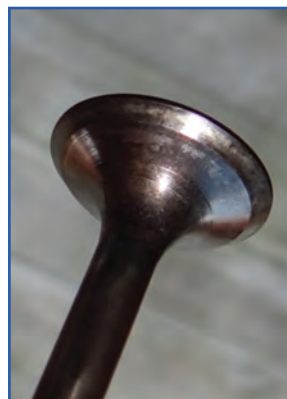
شکل ۴۵-۴- کربن گرفتن بشقابک سوپاپ
