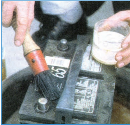
(ب) تمیز کردن با قلم مویی و محلول جوش شیرین
