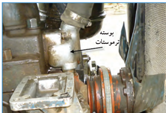
شکل ۳۷-۲- پوسته ترموستات تراکتور U650
