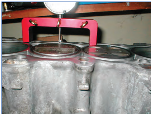
شکل ۲۰۵-۴- کنترل ارتفاع پیستون
