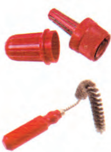
شکل ۲۳-۶- تمیز کردن قطب‌های باتری با ابزار مخصوص
