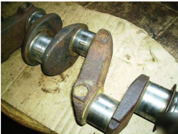
شکل ۲۱۰-۴- میل‌لنگ با رسوبات کربن
