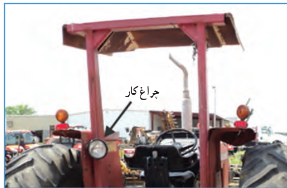
شکل ۱۵-۲- چراغ اصلی عقب تراکتور MF285
