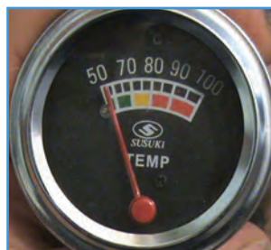
شکل ۱۰-۲- درجه نشان دهنده دمای آب
