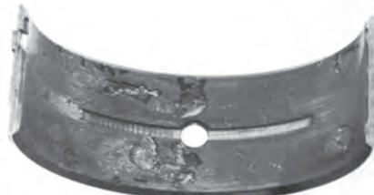
شکل ۱۶۷-۴ نقاط ذوب‌شده روی یاتاقان
