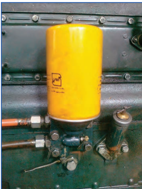
شکل ۱۸-۷- صافی روغن تراکتور U650M
