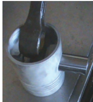
شکل ۱۲۲-۴ اتصال شاتون به پیستون و جازدن انگشتی
