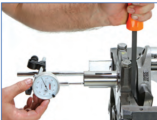
شکل ۱۷۹-۴- اندازه‌گیری لقی طولی میل‌لنگ با ساعت اندازه‌گیری
