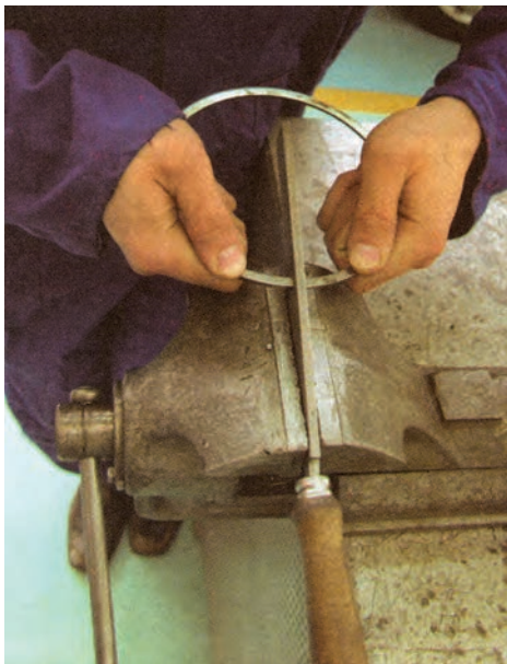
شکل ۱۳۰-۴- ساییدن دهانه رینگ با سوهان
