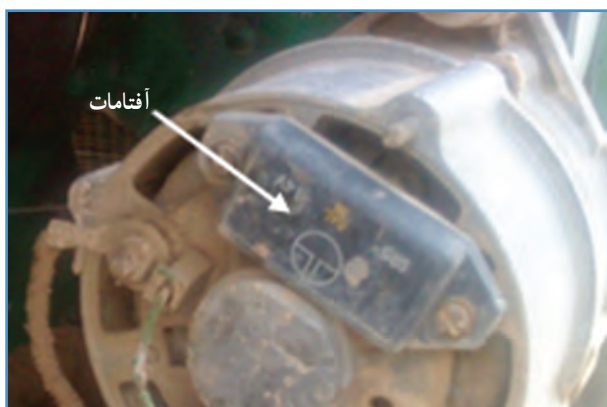
الف) آفتامات روی آلترناتور تراکتور JD3140
