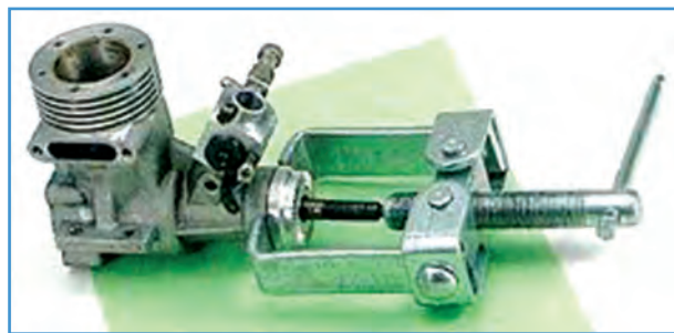
شکل ۷۷-۳- خارج کردن بلبرینگ با بلبرینگ کش
