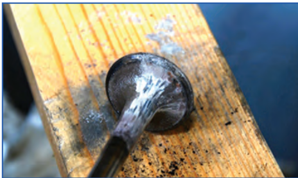
(ب) سوپاپ تمیز شده با کاردک
