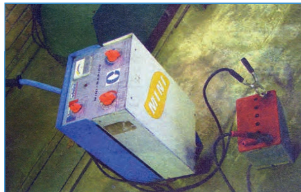
شکل ۱۸-۶ اتصال کابل‌های شارژر به باتری
