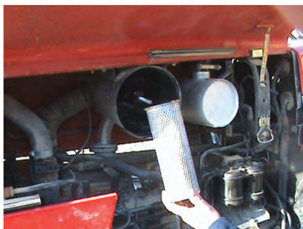
(الف) خارج کردن صافی ثانویه
