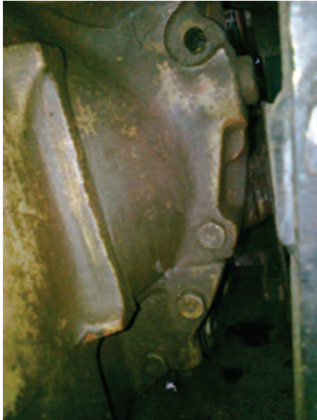
شکل ۱۱-۳- پیچ‌های اتصال موتور به جعبه‌دنده قسمت پایین
