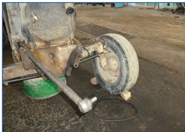
شکل ۱۹-۳- قسمت جلوی تراکتور جدا شده از موتور
