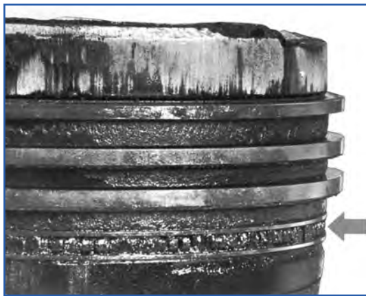
شکل ۱۰۵-۴- تخریب لبه‌های شیار پیستون و وجود لجن روغن در رینگ روغن
