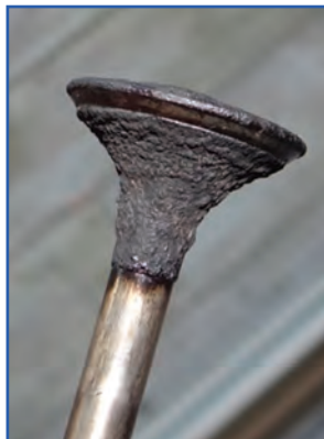
شکل ۴۵-۴- کربن گرفتن بشقابک سوپاپ
