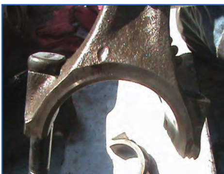
شکل ۱۹۴-۴- جا افتادن قسمت تخت پیچ شاتون در محل آن
