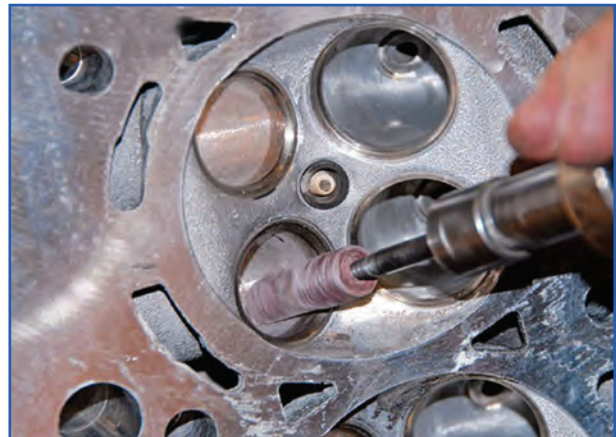
الف) نحوه تمیز کردن محفظه پشت سوپاپ
