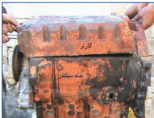
ب) برداشتن کارتر
