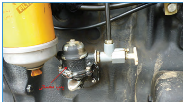
شکل ۲۹-۲- پمپ مقدماتی تراکتور MF285
