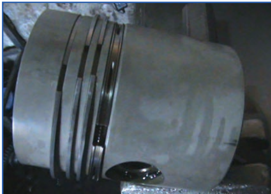
شکل ۱۳۹-۴- ترتیب قرار گرفتن رینگها روی شیار پیستون
