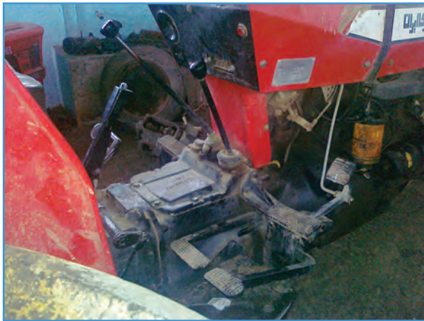
شکل ۲۱-۲- اهرم‌های تعویض دنده و دنده کمک
