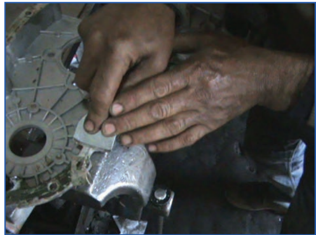
شکل ۴۱-۷- تمیز کردن واشر سینی جلو با کاردک
