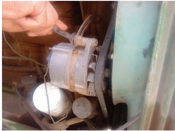
شکل ۳۸- ۶- سفت کردن پیچ تنظیم آلترناتور
