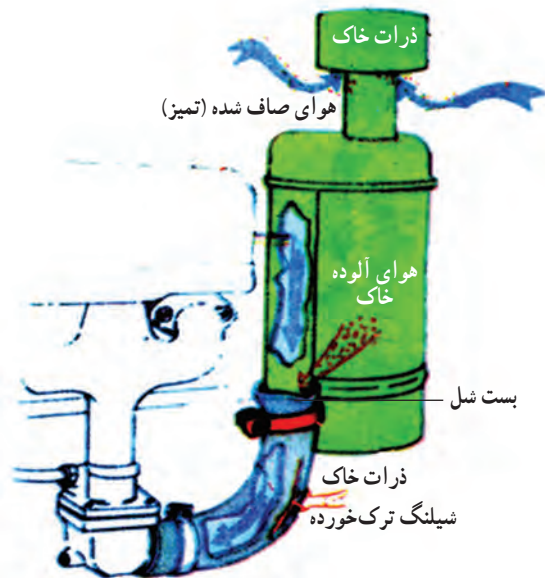
شکل ۱۹-۵- محل بریدگی و سوراخ شدگی در شیلنگ‌ها
