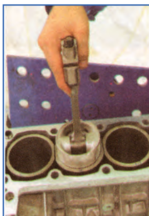
شکل ۱۲۷-۴- طرز قرار دادن رینگ داخل سیلندر
