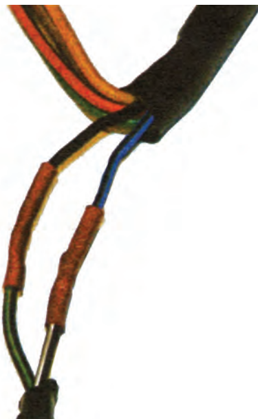
شکل ۶۷-۶- اتصال کامل سیم‌ها با روکش تیوب عایق
