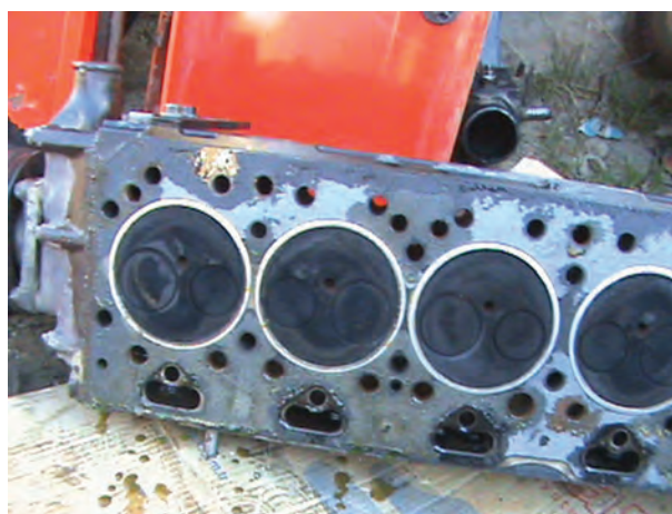
شکل ۱۵-۴- طرز قرار دادن سرسیلندر روی سطح صاف
