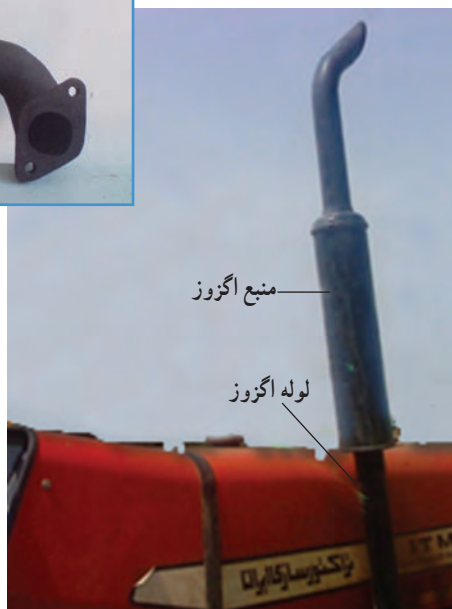
شکل ۲-۵- اگزوز تراکتور MF285
