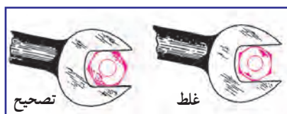
شکل ۲۹-۳ طرز درگیر کردن آچار تخت با مهره
