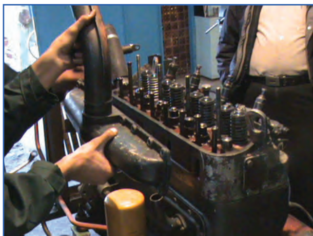
شکل ۴-۴- باز کردن مانیفولد هوا
