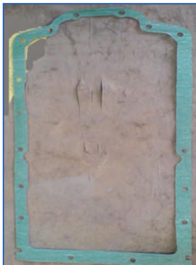
ب) واشر کارتر چوب‌پنبه‌ای MF285
