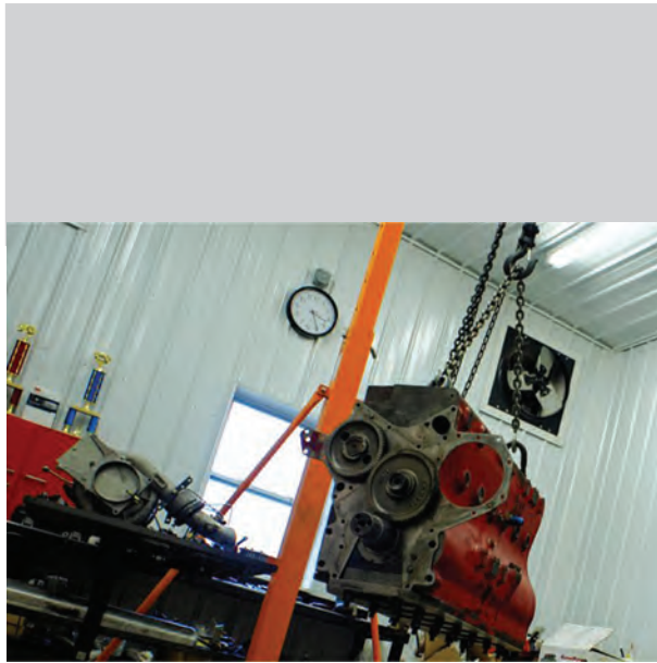
شکل ۱۶-۴- بستن موتور با زنجیر و قلاب
