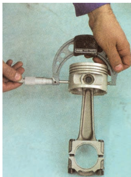
(الف) اندازه‌گیری قطر دامن پیستون
