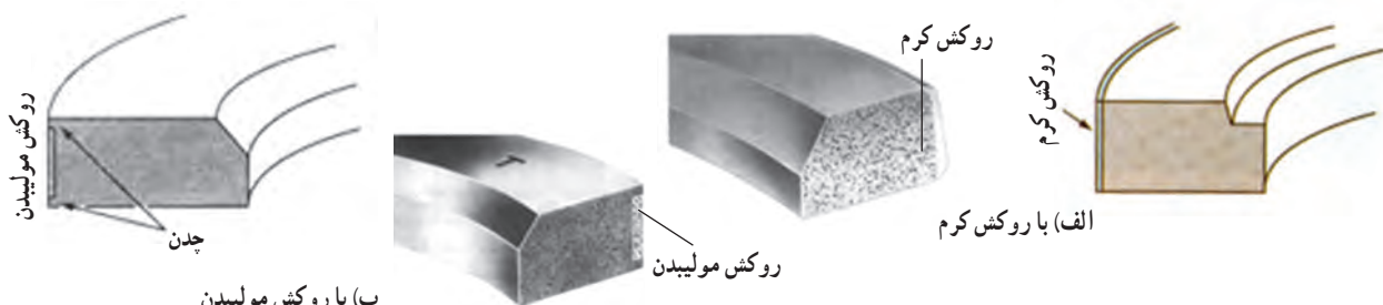
شکل ۲۴-۲- مقطع رینگ‌های تراکم روکش دار
