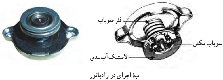
شکل ۳-۵- در رادیاتور و طرز کار سوپاپ‌های آن
