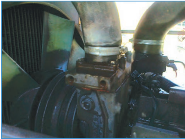
شکل ۱۱-۳- محل بست شیلنگ محفظه ترموستات
