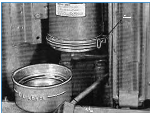
شکل ۱۷-۵- باز کردن پیاله زیر صافی
