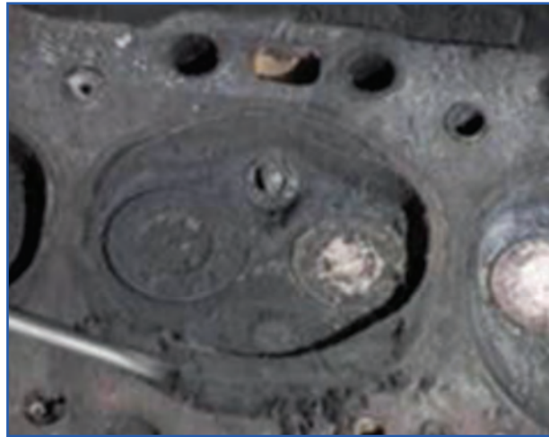
الف) کربن گرفتن سرسیلندر
