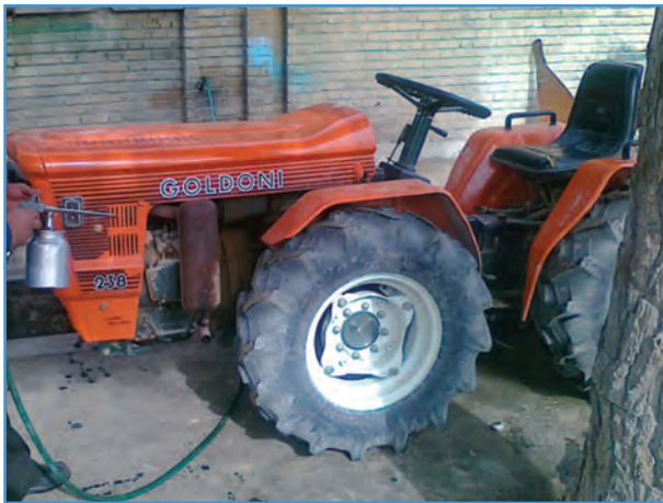
شکل ۴-۱- شستشوی موتور تراکتور با پیستوله شستشو
