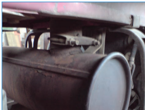
الف) بست اگزوز در تراکتور MF399
