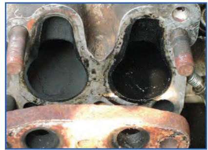
الف) کربن گرفتن مجاری خروج دود روی سرسیلندر
