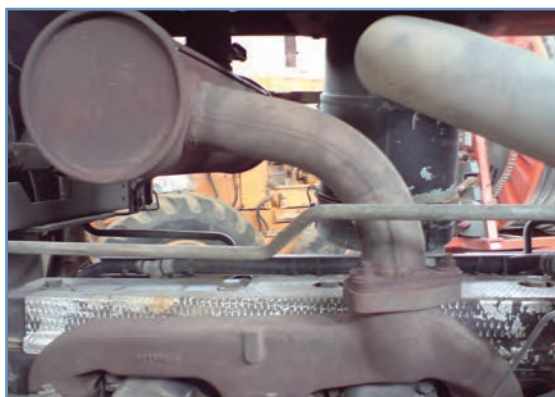
شکل ۳۰-۵- محل اتصال منبع اگزوز به مانیفولد
