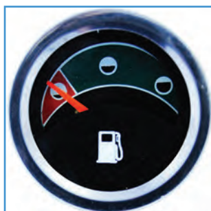
شکل ۹-۲- درجه نشان دهنده مقدار سوخت در مخزن سوخت
