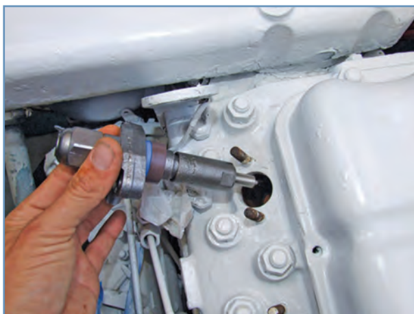
شکل ۲۳-۴- خارج کردن انژکتور
