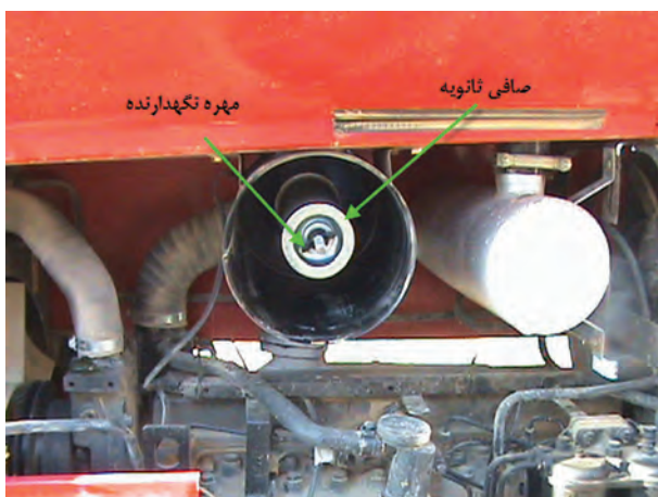
(ب) محل قرار گرفتن صافی ثانویه
