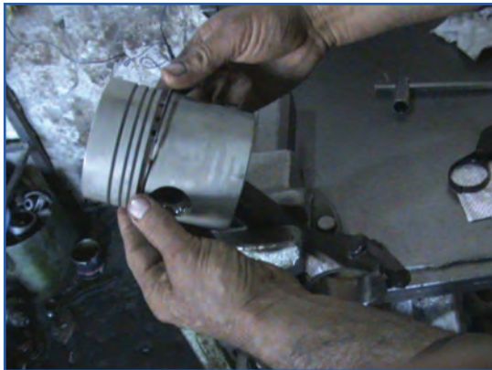
شکل ۱۳۸-۴- جا زدن رینگ با دست
