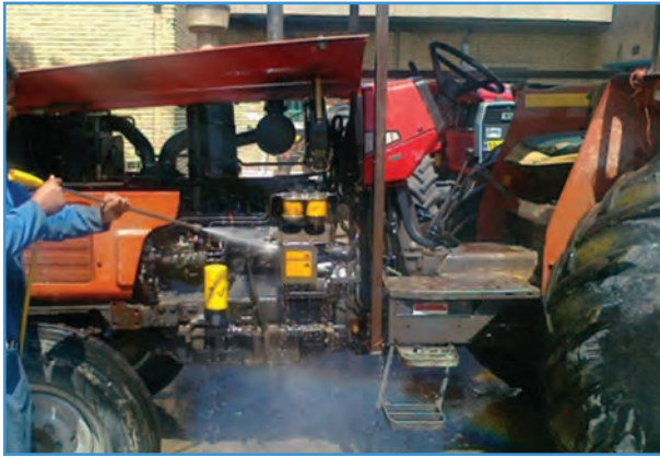
شکل ۵-۱- شستشوی موتور تراکتور
