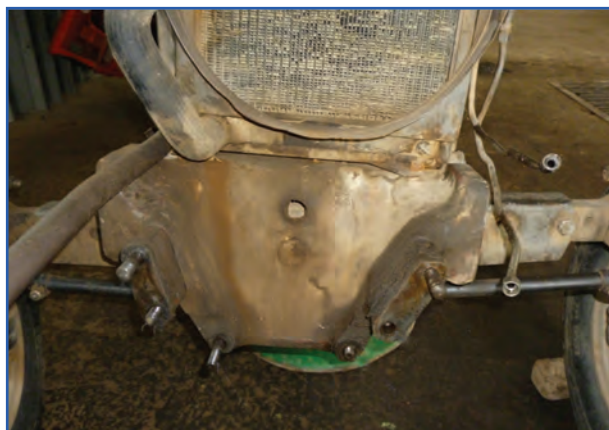
شکل ۲۰-۳- پیچ‌های قسمت جلوی تراکتور که باید به موتور متصل شود.
