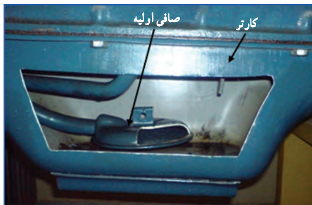
شکل ۲۴-۷- کارتور برش خورده تراکتور U650
