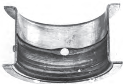
شکل ۱۶۵-۴ خط به دلیل نفوذ ذرات ریز و درشت بین میل‌لنگ و یاتاقان
