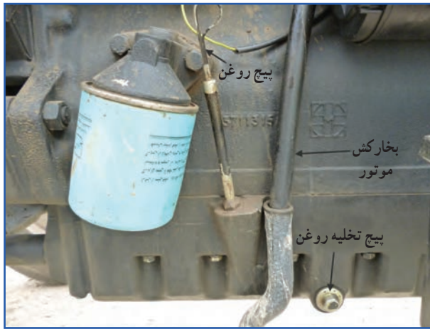
شکل ۲۷-۷- پیچ تخلیه روغن کارتر MF285
