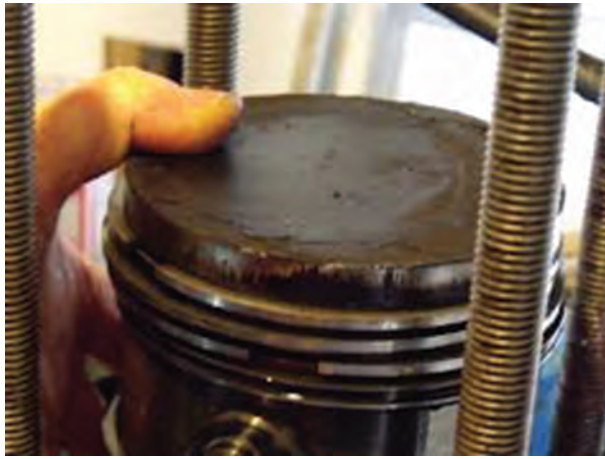
شکل ۲۰۷-۴- رسوبات کربن روی سطح پیستون
