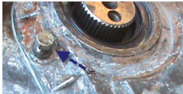
شکل ۴-۶۳- بین هم مرکز کننده کاسه نمد و محور سر میل‌لنگ
