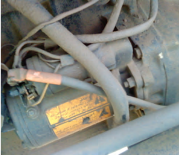
شکل ۶-۴۳- اتصال سیم‌ها از دینام به آفتمات
