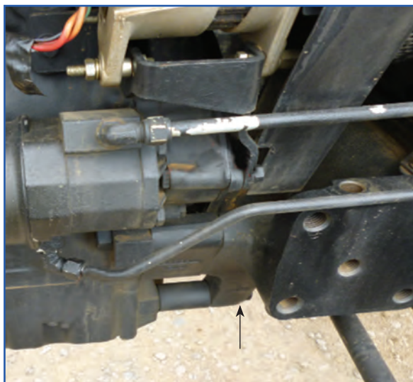
شکل ۱۷-۳- محل پیچ‌های اتصال موتور به جلوی تراکتور
