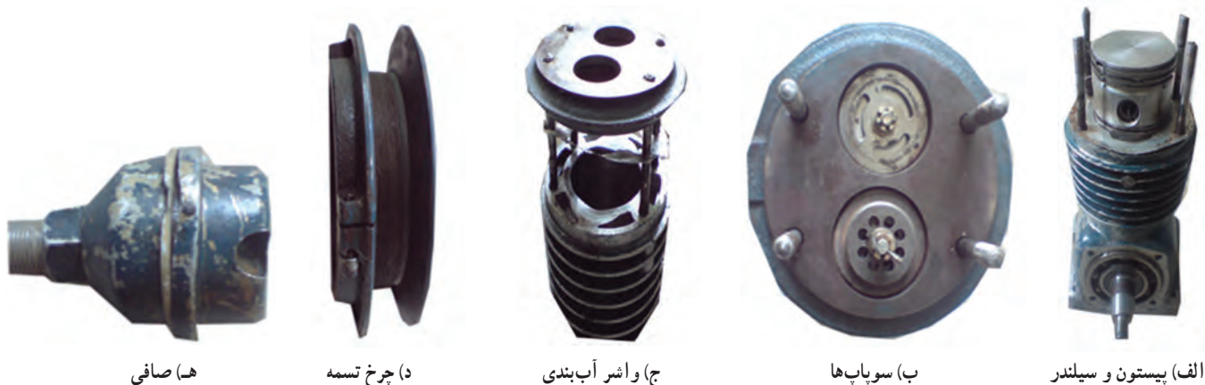
شکل ۳-۸- اجزای کمپرسور باد
