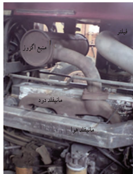
شکل ۲-۵- محل مانیفولد دود و هوا در تراکتور MF399
