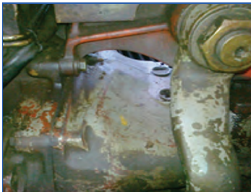
شکل ۹-۳- پیچ‌های اتصال موتور به جعبه‌دنده قسمت بالا
