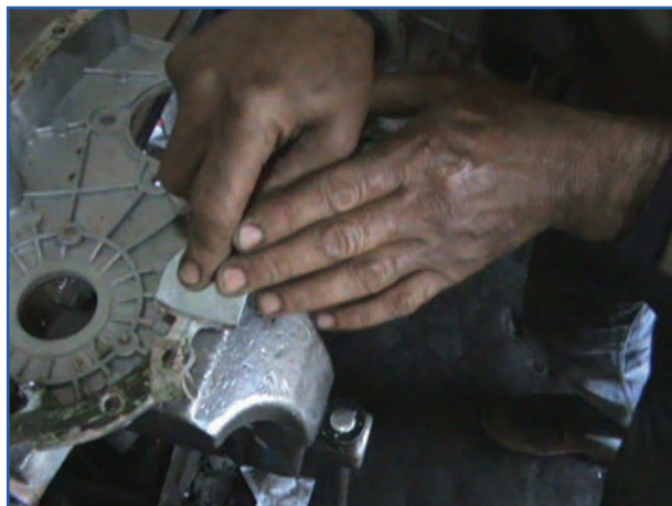
شکل ۷۶-۴- تمیز کردن واشر محفظه جلو موتور
