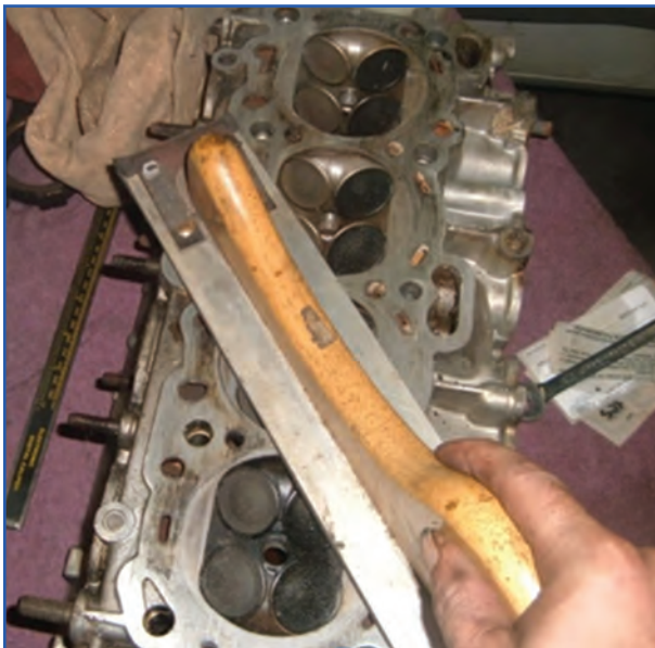
شکل ۴۴-۴- تمیز کردن سرسیلندر با سوهان نرم
