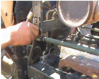
ج) باز کردن شاسی نگهدارنده رادیاتور
