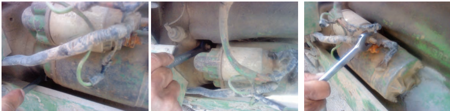
شکل ۵۰-۶ باز کردن کابل مثبت از استارت
