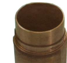
ج) شیار اورینگ روی بوش تر
