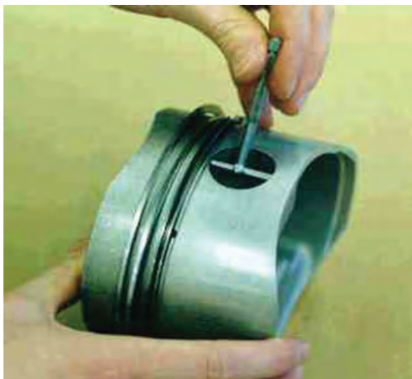
شکل ۱۱۷-۴- اندازه‌گیری سوراخ انگشتی روی پیستون
