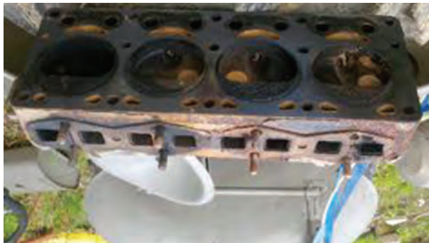
شکل ۲۰۹-۴- رسوبات کربن سطح سرسیلندر
