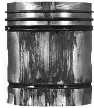
الف) خط و خش روی پیستون
