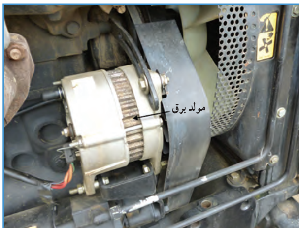
شکل ۴۷-۲- مولد برق تراکتور MF285
