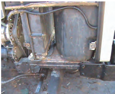
و) باز کردن بست نگهدارنده باک
