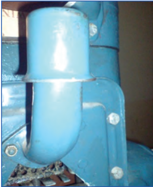
شکل ۲۹-۷- هواکش روغن U650M
