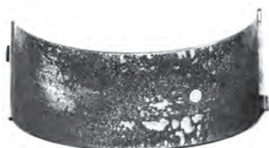
شکل ۱۶۸-۴ اثرات سوختگی روی یاتاقان
