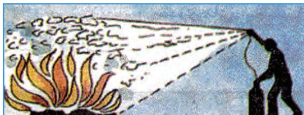
شکل ۱۵-۱- خاموش کردن آتش با کف
