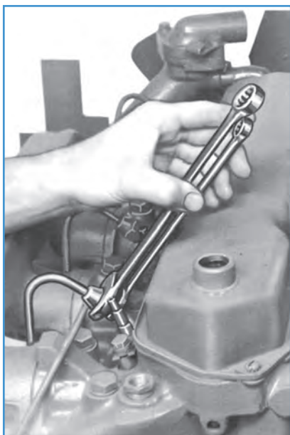
شکل ۲۲-۴- باز کردن لوله‌های فشارقوی انژکتورها
