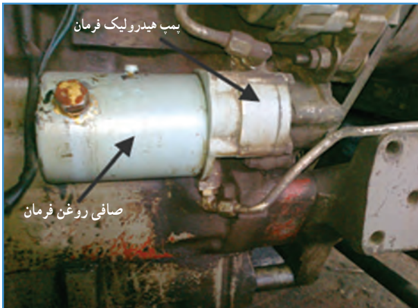
شکل ۲۳-۲- پمپ هیدرولیک فرمان و صافی تراکتور MF285
