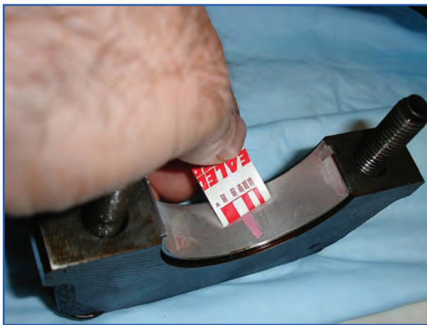
شکل ۱۷۷-۴- وضعیت پلاستیکی گیج قبل و بعد از آزمایش لقی میل‌لنگ
