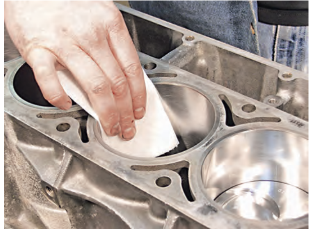
شکل ۲۰۸-۴- تمیز کردن داخل سیلندر
