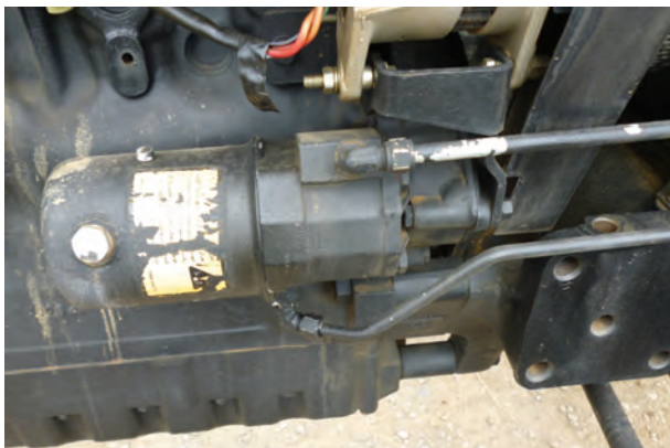
شکل ۱۴-۳- لوله‌های پمپ فرمان
