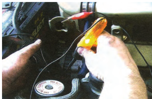
شکل ۷۷-۶- اتصال لامپ آزمایش به مدار
