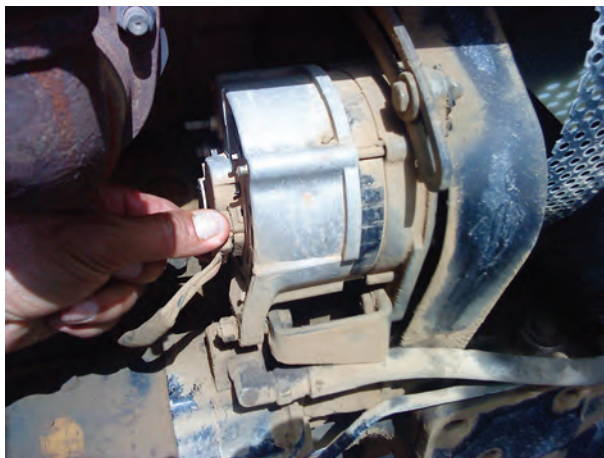
شکل ۲۸-۶- جدا کردن فیش از آلترناتور
