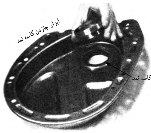
شکل ۴۳-۷- نحوه جازدن کاسه نمد روی سینی جلو
