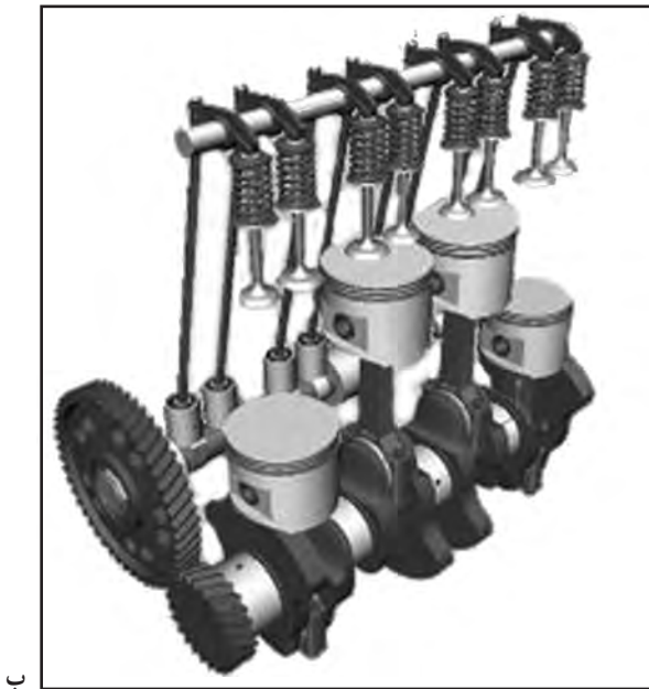
شکل ۸-۲ - قطعات مکانیزم باز و بسته شدن سوپاپ‌ها
