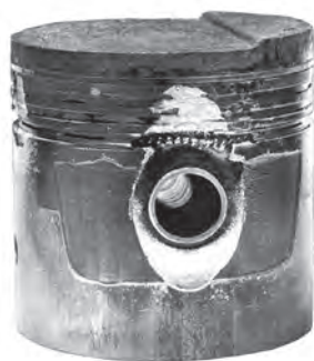
شکل ۴-۱۰۳- سایش غیریکنواخت پیستون
