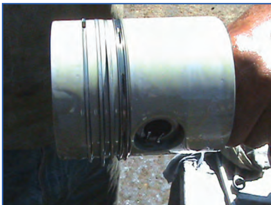
شکل ۱۴۰-۴- روغن کاری همه رینگها و پیستون
