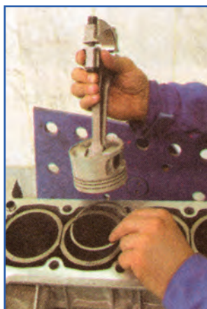
شکل ۱۲۷-۴- طرز قرار دادن رینگ داخل سیلندر
