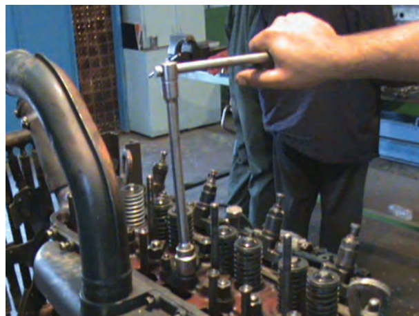
الف) باز کردن پیچ‌های سرسیلندر تراکتور U650
