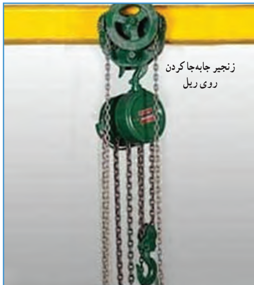
شکل ۲۰-۴- اتصال جرثقیل سقفی به ریل
