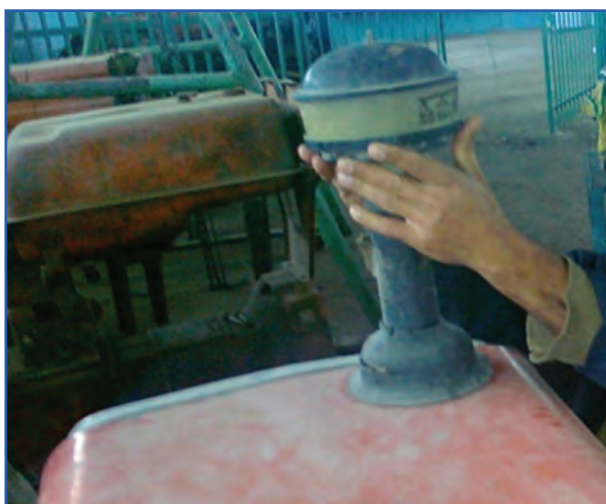
شکل ۲-۳- باز کردن پیش صافی
