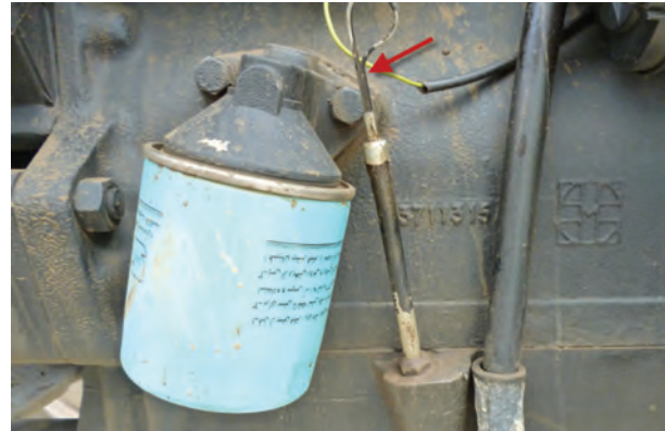
شکل ۳۰-۷- میله سنجش سطح روغن تراکتور MF285
