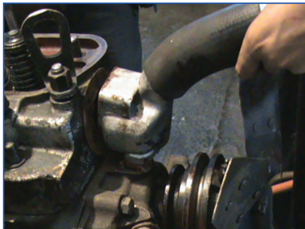
(الف) باز کردن محافظه ترموستات تراکتور U650
