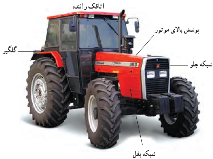
شکل ۲-۲- بدنه و پوشش‌های تراکتور مسی فرگوسن (MF399)
