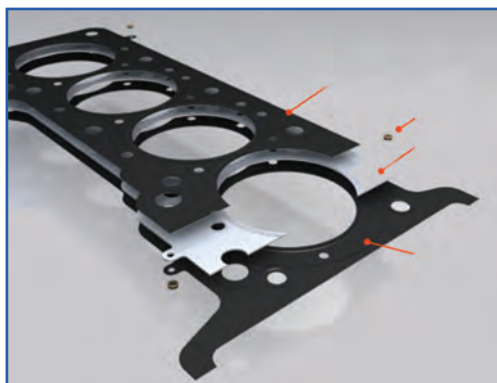
شکل ۴-۴۹ - ساختمان واشر سرسیلندر
