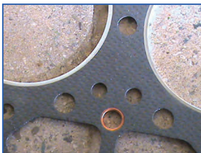
ب) سمت باریک نوار فلزی واشر سرسیلندر
