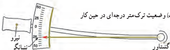
شکل ۳-۵۵- ترک متر درجه‌ای
