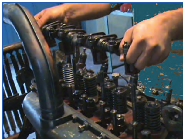
شکل ۹-۴ - برداشتن محور اسبک و اسبک‌ها تراکتور U650
