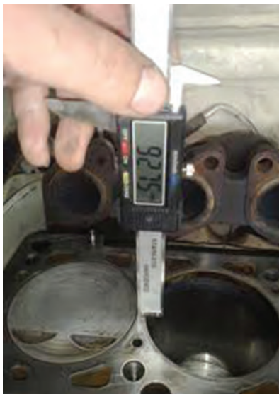
شکل ۱۴۵-۴- اندازه‌گیری بیرون زدگی بوش از روی سیلندر
