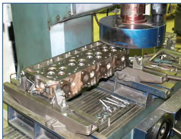
شکل ۳۲-۴- دستگاه کف تراشی سرسیلندر
