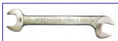
شکل ۲۸-۳ آچار تخت با سر زاویه دار (اینجی)
