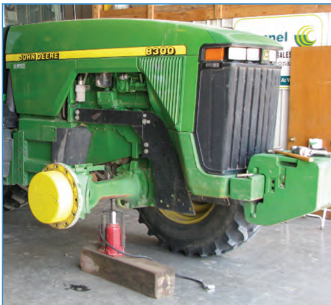
شکل ۱۱-۴- قرار دادن جک روغنی زیر جسم سنگین
