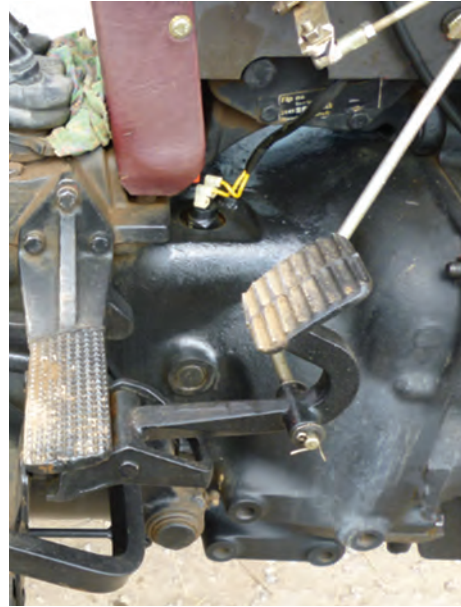
شکل ۱۱-۳- پیچ‌های اتصال موتور به جعبه‌دنده قسمت پایین
