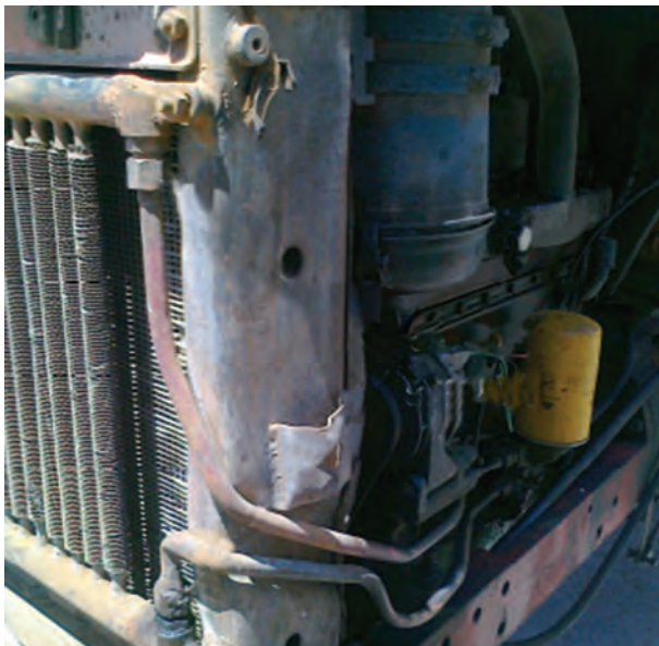
شکل ۱۲-۳- محل مهره‌های رادیاتور روغن
