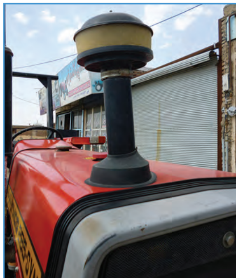
شکل ۲۵-۲- پیش صافی تراکتور MF285
