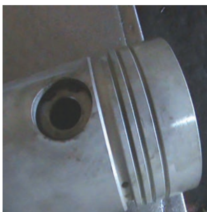
شکل ۱۲۳-۴ میزان داخل شدن انگشتی در پیستون
