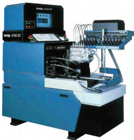
شکل ۲۴-۴ دستگاه آزمودن و تنظیم پمپ انژکتور
