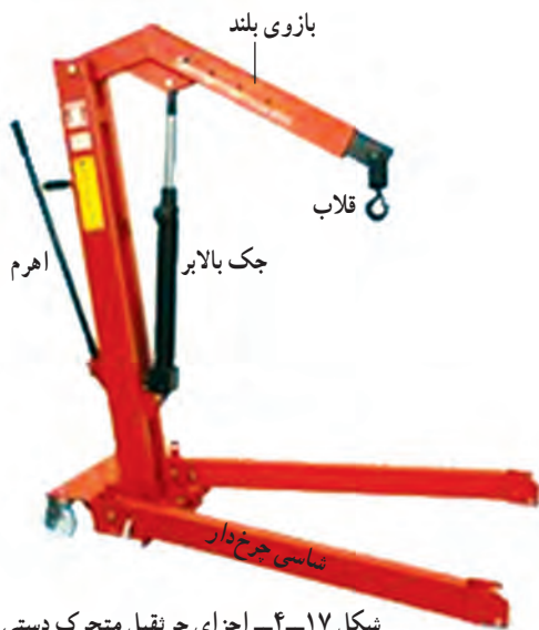
شکل ۱۷-۴- اجزای جرثقیل متحرک دستی
