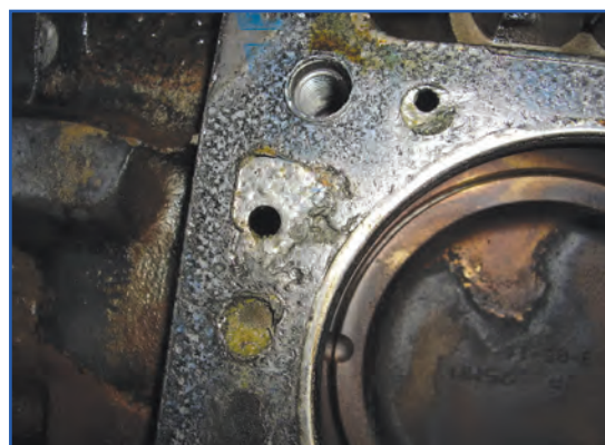
شکل ۴۲-۴- واشر سرسیلندر چسبیده به سیلندر
