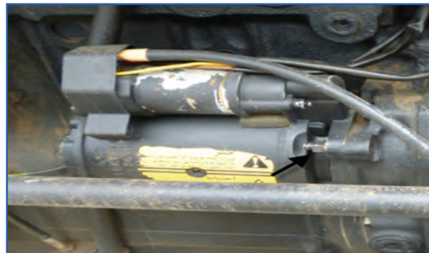
شکل ۳-۸ – پیچ‌های نگه‌دارنده استارت تر تراکتور MF285
