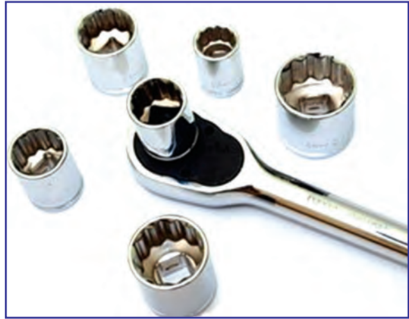
شکل ۴۸-۳- اتصال بکس به دسته بکس جفجغه ای
