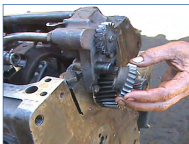
شکل ۸۰-۴- خارج کردن چرخ‌دنده بپمپ روغن
