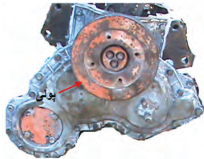
شکل ۴-۶۴- پولی نصب‌شده روی میل‌لنگ
