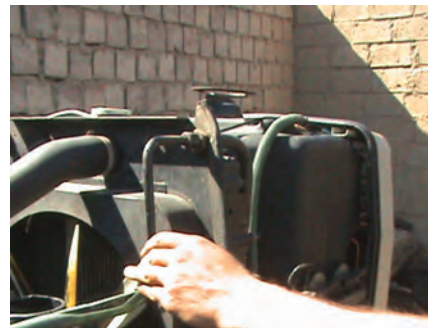
د) باز کردن لوله خنک کن روغن
