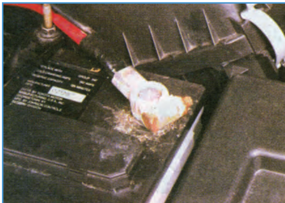
شکل ۲۱-۶- سولفاته کردن بست مثبت باتری
