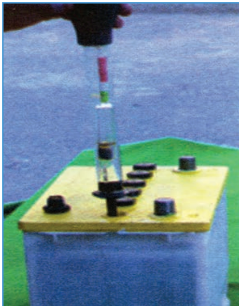
شکل ۴-۶- نحوه اندازه‌گیری غلظت محلول الکترولیت باتری با هیدرومتر دستی
