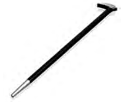
شکل ۷۲-۳- اهرم مخصوص خارج کردن انزکتور
