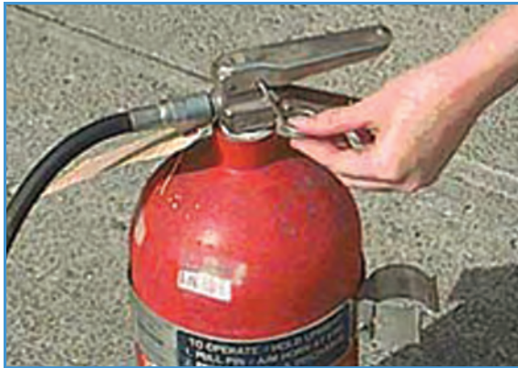
شکل ۱۱-۱- نحوه خارج کردن ضامن کپسول
