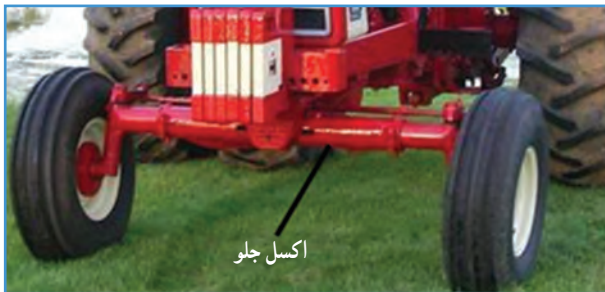
شکل ۲۲-۲- اکسل جلو تراکتور
