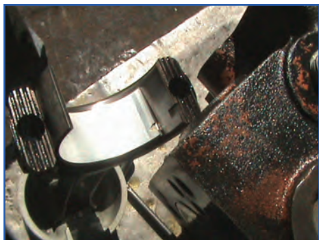
شکل ۱۹۳-۴- جا افتادن گودی یاتاقان‌ها در شیار مربوط به آن
