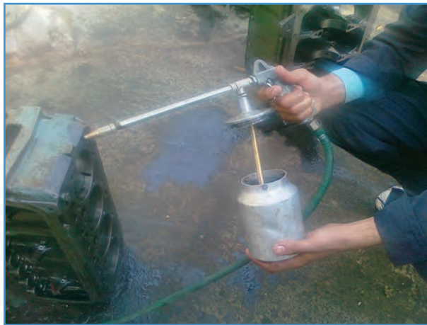
شکل ۳-۱- باز کردن مخزن پیستوله شستشو
