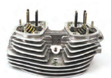
شکل ۳-۲ - سر سیلندر موتور هوا خنک
