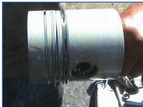
شکل ۱۹۲-۴- روغن‌کاری رینگ‌ها، پیستون و یاتاقان
